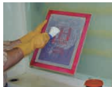
Aplicar o removedor de emulsão nas partes interna e externa da matriz, esfregando com uma brocha de nylon
